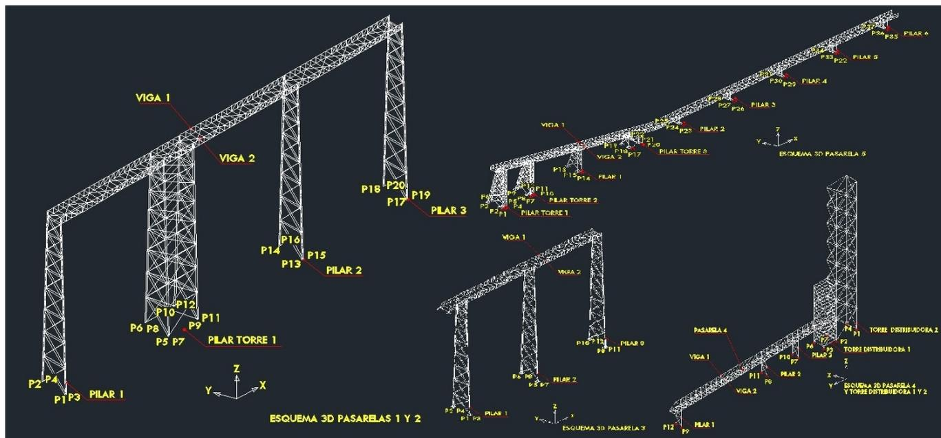
Calculo y dimensionamiento de las estructuras metálicas de 7 pasarelas para cintas transportadoras de grano sobre el Río Estiba, a distintos niveles, y 2 torres de distribución que contiene el equipamiento necesario para distribuir el cereal.
