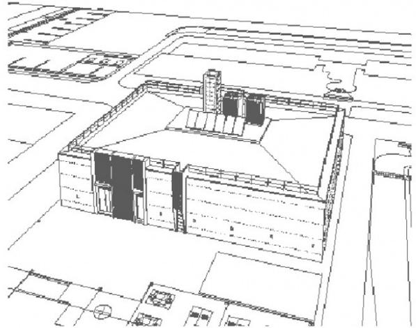
El edificio se dimensiono con la singularidad de que debía ser capaz de soportar la eventual explosion de los depositos de la refinería que estan proximos.
